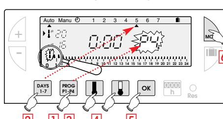
Im unteren Teil des Displays wird ein aus 48 Thermometern bestehendes 24 Std. Profil angezeigt, an dem Sie die Zusammensetzung Ihres Programms ganz deutlich ablesen können.
