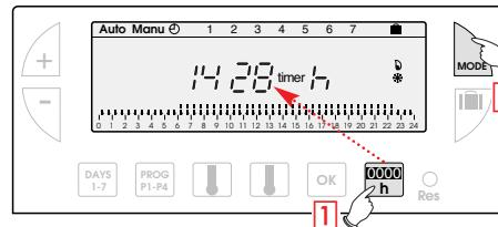
1 Nachdem Sie die Taste **0000 h** gedrückt haben, wird Ihnen auf dem Display die Anzahl der Betriebsstunden seit dem Einsetzen der Batterien angezeigt, d.h. die Anzahl der Stunden, in denen Ihr Brenner, Ihre Klimaanlage, Ihr Heizlüfter oder ein anderes Gerät, das Sie angeschlossen haben, eingeschaltet war. (der Taste + oder - wird der Zähler auf Null gesetzt).
