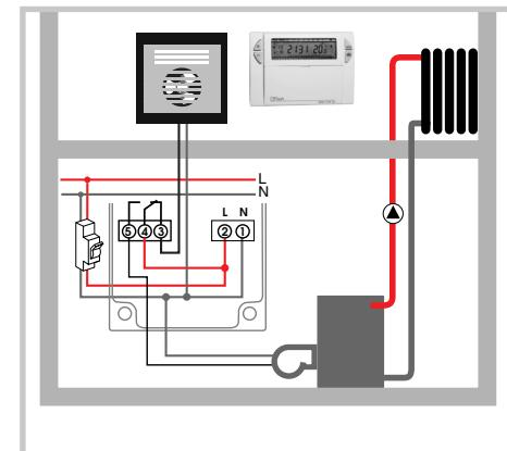
**!** Falls Sie den Thermoflash DIGI 2 HF für Heizung und Kühlung Steuerung verwenden, müssen Sie achten, dass beide Systeme (Heizung und Kühlung) nicht während der selbe Jahreszeit funktionieren.
