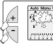
L'indicatore del livello di temperatura in corso (comfort o economia), si mette a lampeggiare. La modifica terminerà al prossimo cambio di temperatura programmato.
